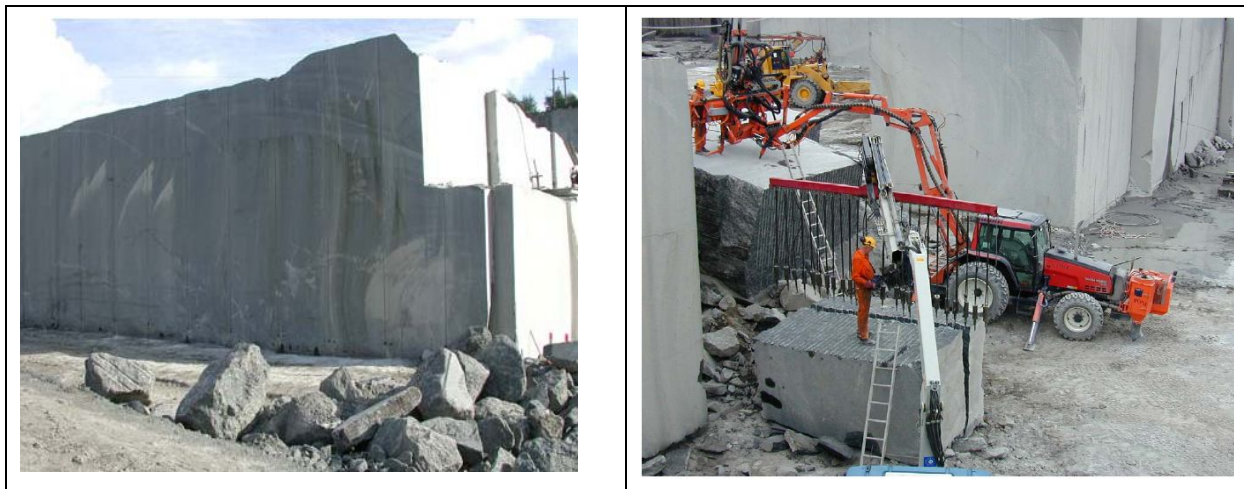
Figur 5 Produksjon av larvikitt - fra fjell til blokk
